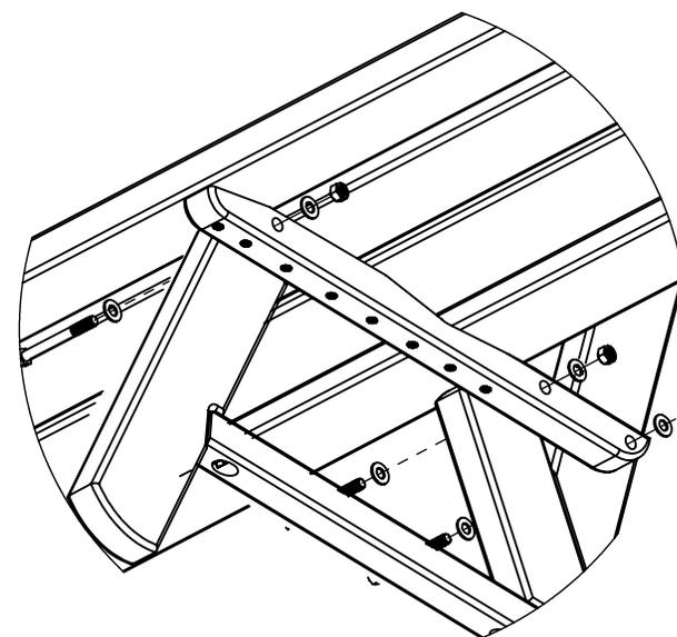
NOTE: BE SURE SPACING BETWEEN SEAT LEG ASSEMBLY A & B IS THE SAME AS THE SPACING AS B & C.
